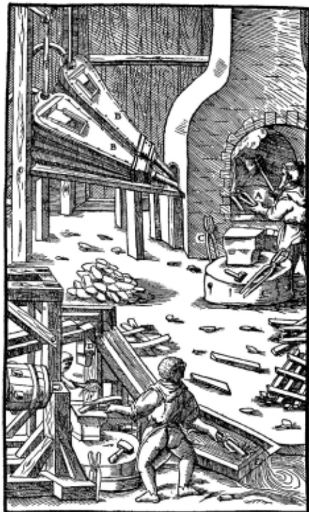
Das Pfriehstueck A. Die Blüthle B. Die Zangen C. Der Hammer D. Das flüssige Waßer E.
